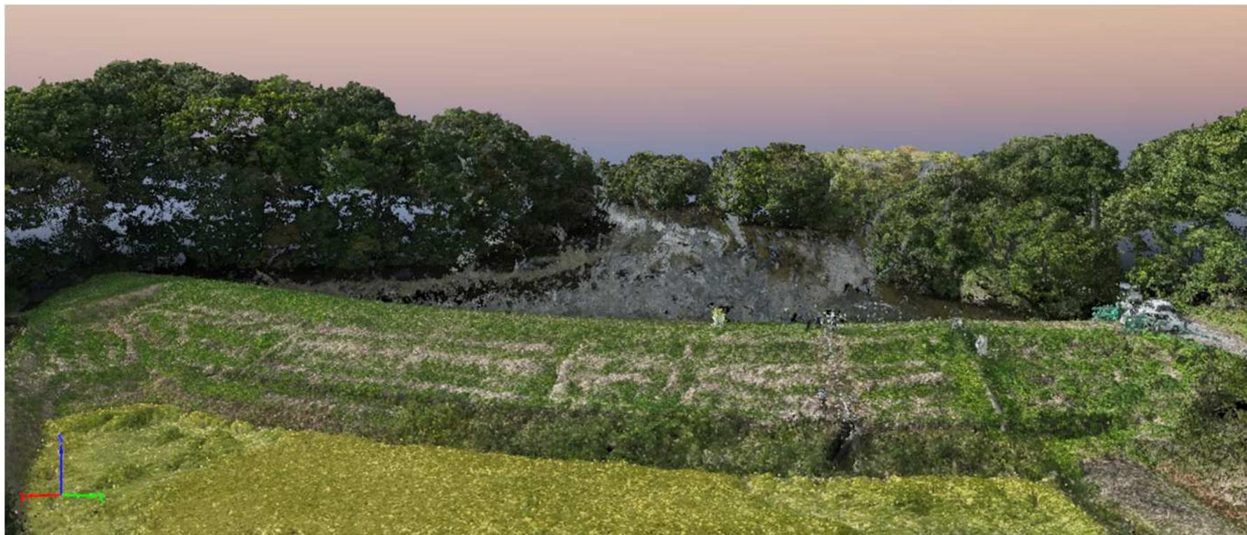
RTKドローンで撮影したデータは、正確な位置情報（位置座標）も取得できますので、撮影写真をつなぎ合わせたオルソ画像は、GISソフトなどを使えば、国土地理院地図などに重ねて表示ができます。一般的にインターネットを介して提供されるgoogle アースなどの航空写真より解像度が高く、詳細な現地確認が可能であり、ライセンス規約など使用上の制限なく業務等に活用できます。
