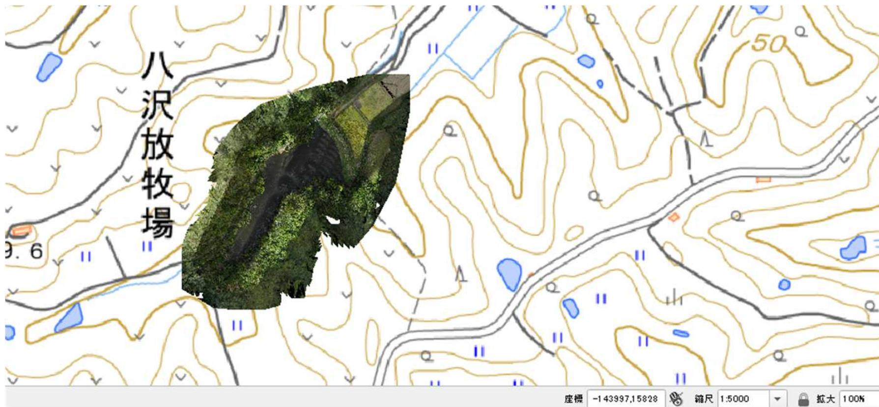
さらに、オルソ画像は正確な位置情報（位置座標）を持っているため、平面図としても活用可能で、画像上で面積や延長も計測することができます。※ため池を囲むと 12,131.707m<sup>2</sup> であることが分かります。
